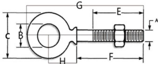
G277吊环螺丝带垫片与螺母 UNC美制丝 AISI304/316
