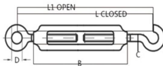
欧式开体花兰-OC型/OC型/CC型 AISI304/316
